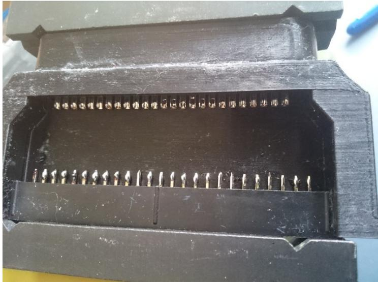
Die anschließende Verdrahtung von den Lötkelchen her beginnen. Den Draht so ablängen, das er bis zur Mitte der Lötstifte des Wannensteckers reicht. Mit der Pinzette das Drahtende beim verlöten auf den Lötstift drücken. Siehe nächstes Bild.
