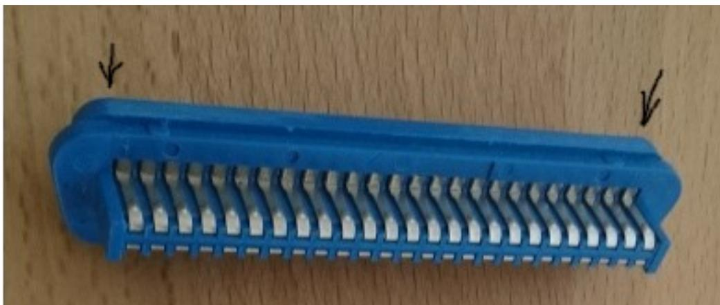
einer Nagelfeile), da er sonst nicht optimal in die vorgesehene Aussparung am Griffträger paßt. Zu bearbeitende Stellen siehe Bild oben, markiert durch Pfeile. Die links gut zu erkennende Kante muß (an allen vier Ecken) schräg,
