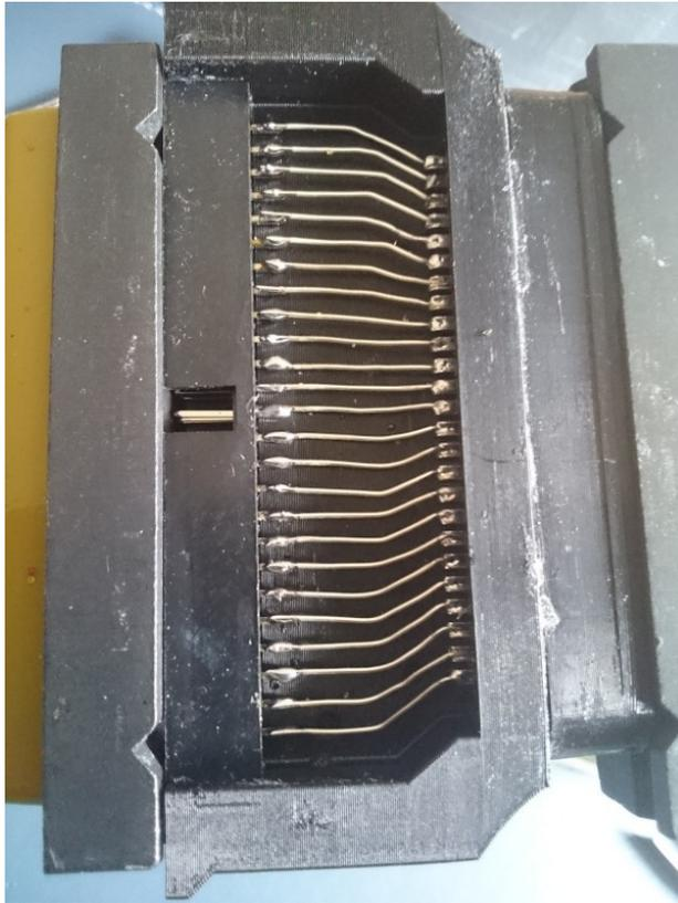
Eine Kontrolle der Lötungen ist angeraten, kalte Lötstellen sind wahrscheinlich. Sind beide Seiten bedrahtet, kann die Abdeckung aufgesteckt und verschraubt werden - Adapter fertig.
