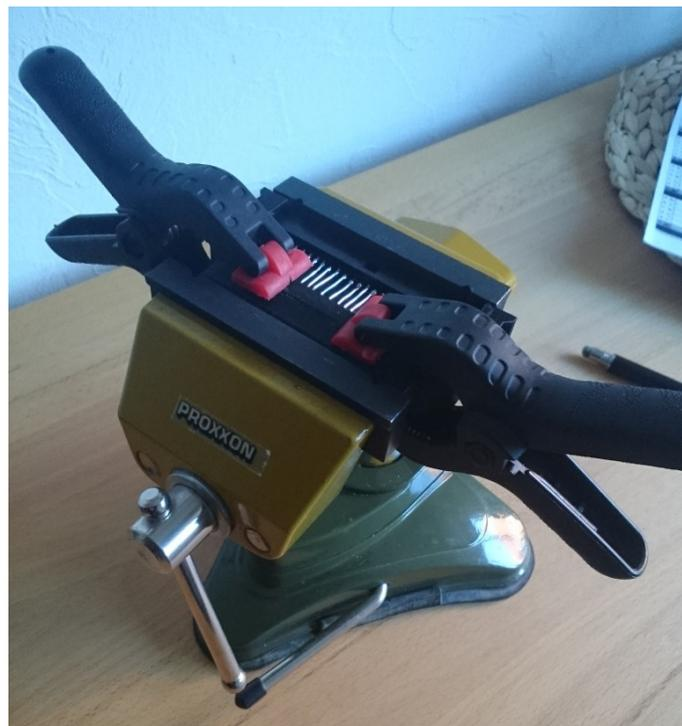
Zum Einsetzen des Kontaktkopfes bzw. des Wannensteckers am besten den Griffträger an den beiden Flächen mit der Spaxschraube halten. Sind beide Teile in Position und lückenlos vom Kleber umschlossen, ist die Anordnung wie im nachfolgenden Bild gezeigt für ca. 10 Min. einzuspannen (im Bild bereits
