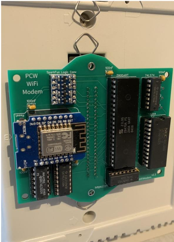
Hier ist das Modem noch ohne das Gehäuse zu sehen, auf der Rückseite der Joyce im Centronics-Port eingesteckt.
